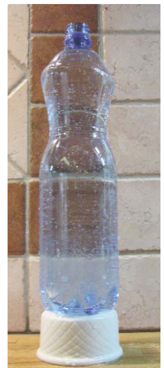
Figure 10: dès que la pression baisse, une partie de l'acide carbonique se décompose et du \text{CO}_2 et reprend sa forme gazeuse.
